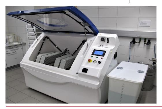
Humidity test 480 h DIN EN ISO 6270-2 CH
